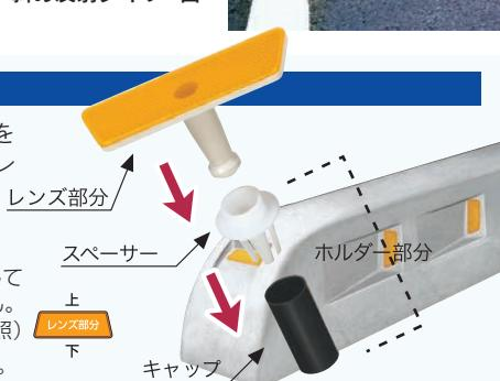
■セーフアイCB取付時は製品の上下を確認して下さい。上下を逆に取付けると反射しません。
